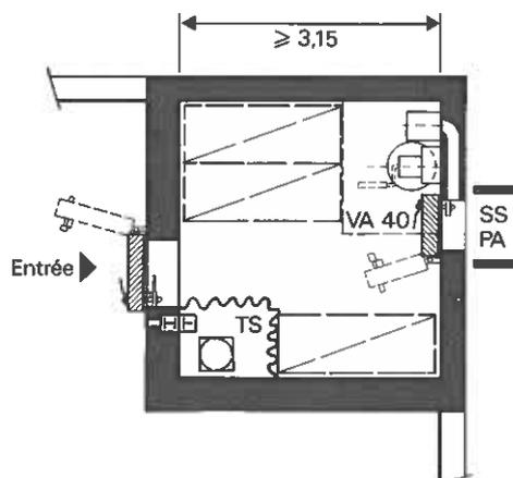
Figure 2.4-4 Configuration d'un abri de 9 places protégées (surface  $\geq 10$  m<sup>2</sup>)
