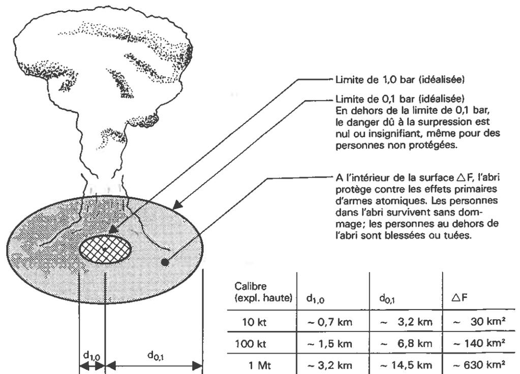
*Figure 1.2-2 Surfaces idéalisées soumises à la surpression par l'explosion d'armes atomiques de 10 kt, 100 kt et 1 Mt à hauteurs d'explosion optimales.*
