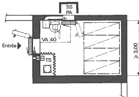
Figure 2.4-6 Configuration d'un abri de 12 places protégées (surface  $\geq 13$  m<sup>2</sup>)
