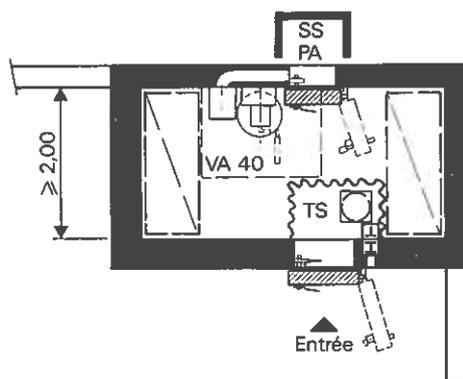
Figure 2.4-2 Configuration, forme oblongue, d'un abri de 5 à 7 places protégées (surface minimale 8 m<sup>2</sup>)
