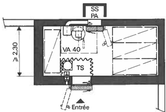
Figure 2.4-5 Configuration d'un abri de 10 places protégées (surface  $\geq 11$  m<sup>2</sup>)
