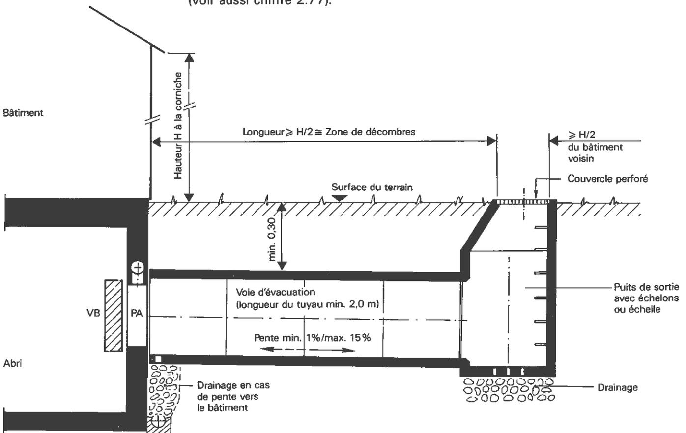
Figure 2.7-3 Configuration de la voie d'évacuation, coupe longitudinale
