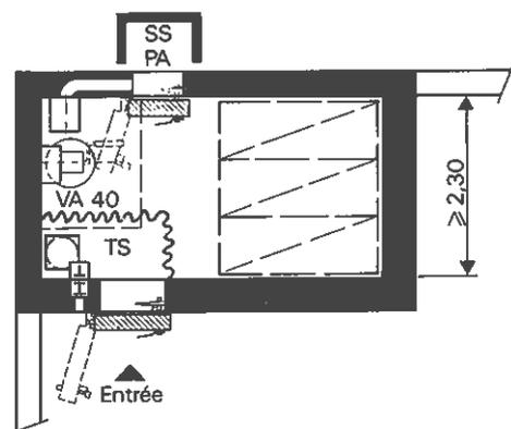
Figure 2.4-3 Configuration d'un abri de 8 places protégées (surface  $\geq 9$  m<sup>2</sup>)
