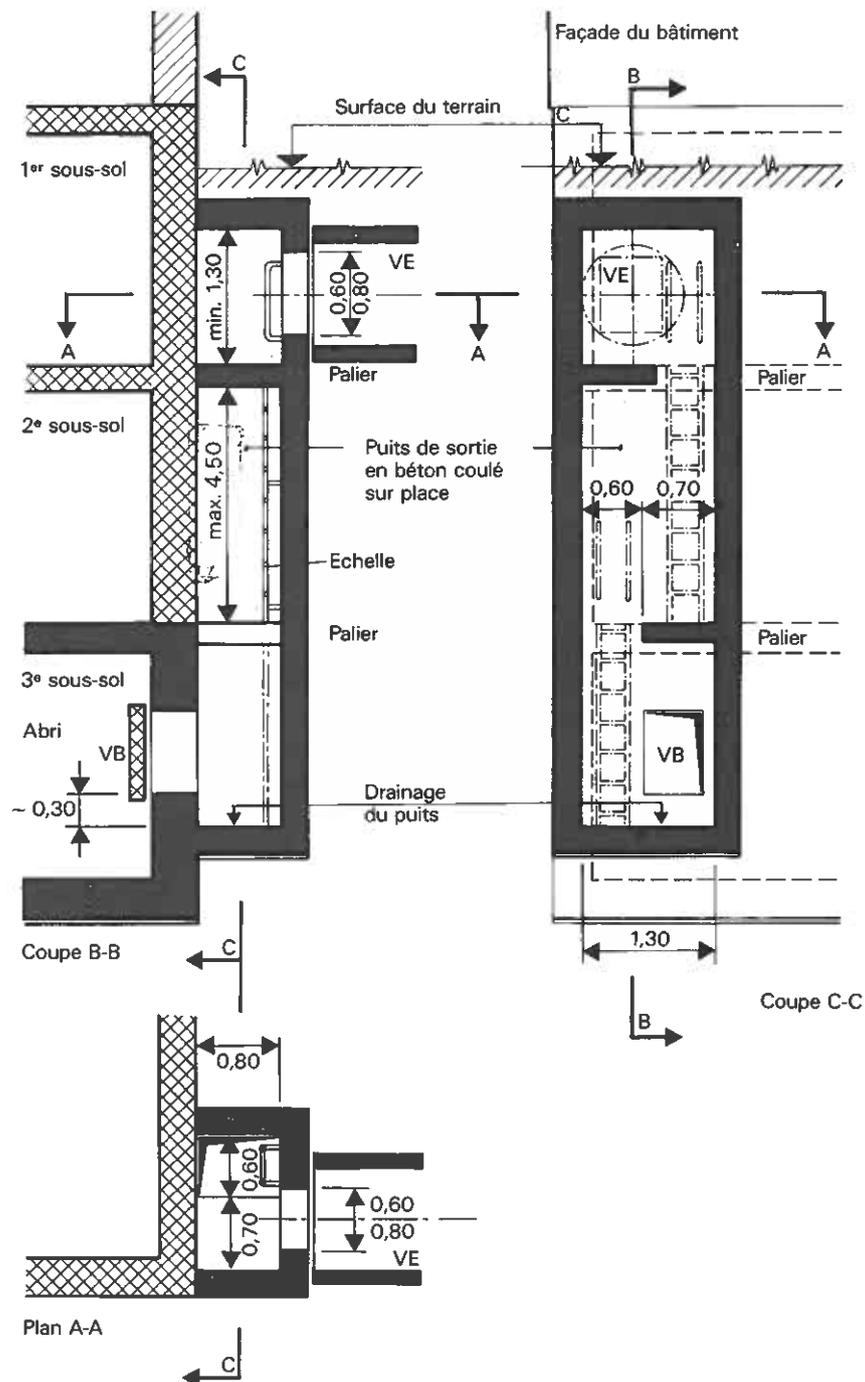
Figure 2.7-7 Configuration du puits de sortie d'abris en profondeur
