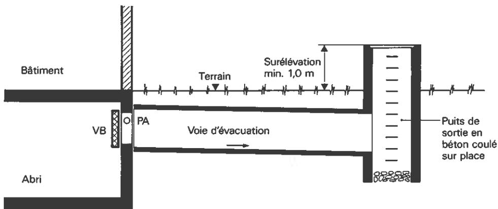
Figure 2.3-1 Voie d'évacuation avec puits de sortie surélevé
