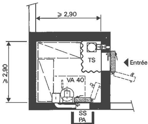
Figure 2.4-1 Configuration, forme carrée, d'un abri de 5 à 7 places protégées (surface minimale 8 m<sup>2</sup>)
